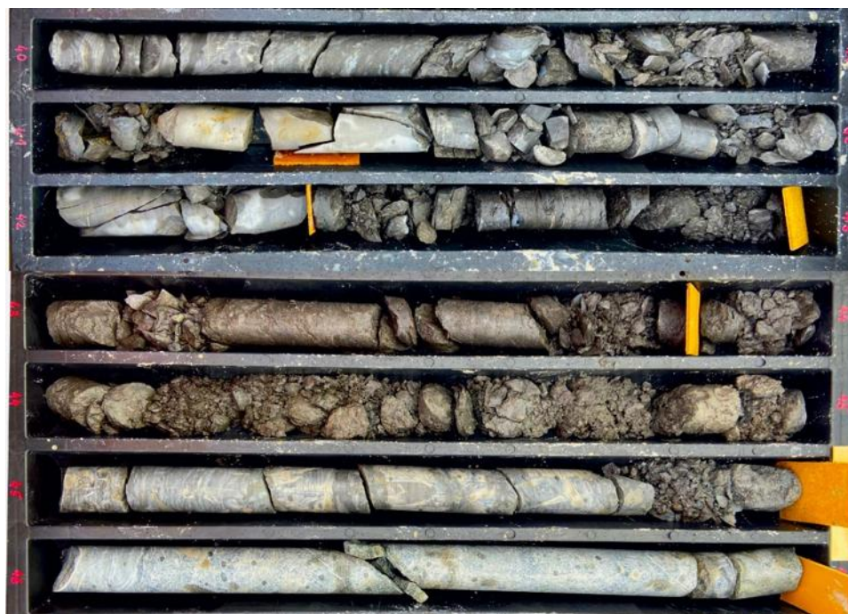
Obr. 3 Zastižení tachlovického přesmyku ve vrtu J30, hloubkový úsek 40–47 m. V nadloží poruchové zóny se nacházejí starší břidlice a křemence kosovského souvrství (ordovik), v podloží byly zastiženy mladší břidlice a bazalty motolského souvrství (silur).
